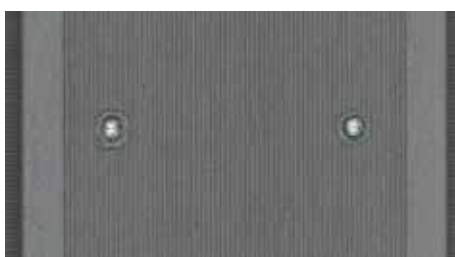
Résidus de production sur les points de vissage des lames JUMBO Bois Composite
