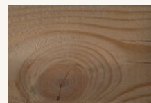
Nœuds sur une surface à caractère
